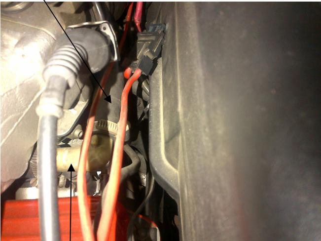
Winkelstück hinten am 5. Zylinder, danach gerader Verlauf unter dem Saugbrückenoberteil direkt zum Leerlaufregler
