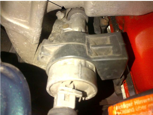
Vom Leerlaufregler zum Anschluß an den 3. Zylinder des Saugrohrunterteils
