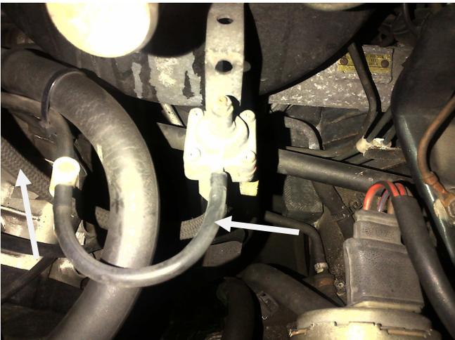
Am Thermostaten im Wärmetauscherrücklauf
