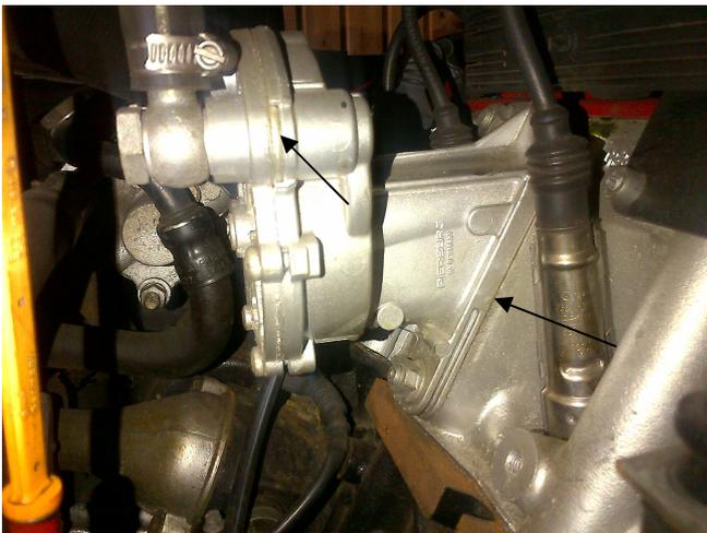
Dann sind entweder die Kurbelgehäuseentlüftung oder der Saugschlauch betroffen.
