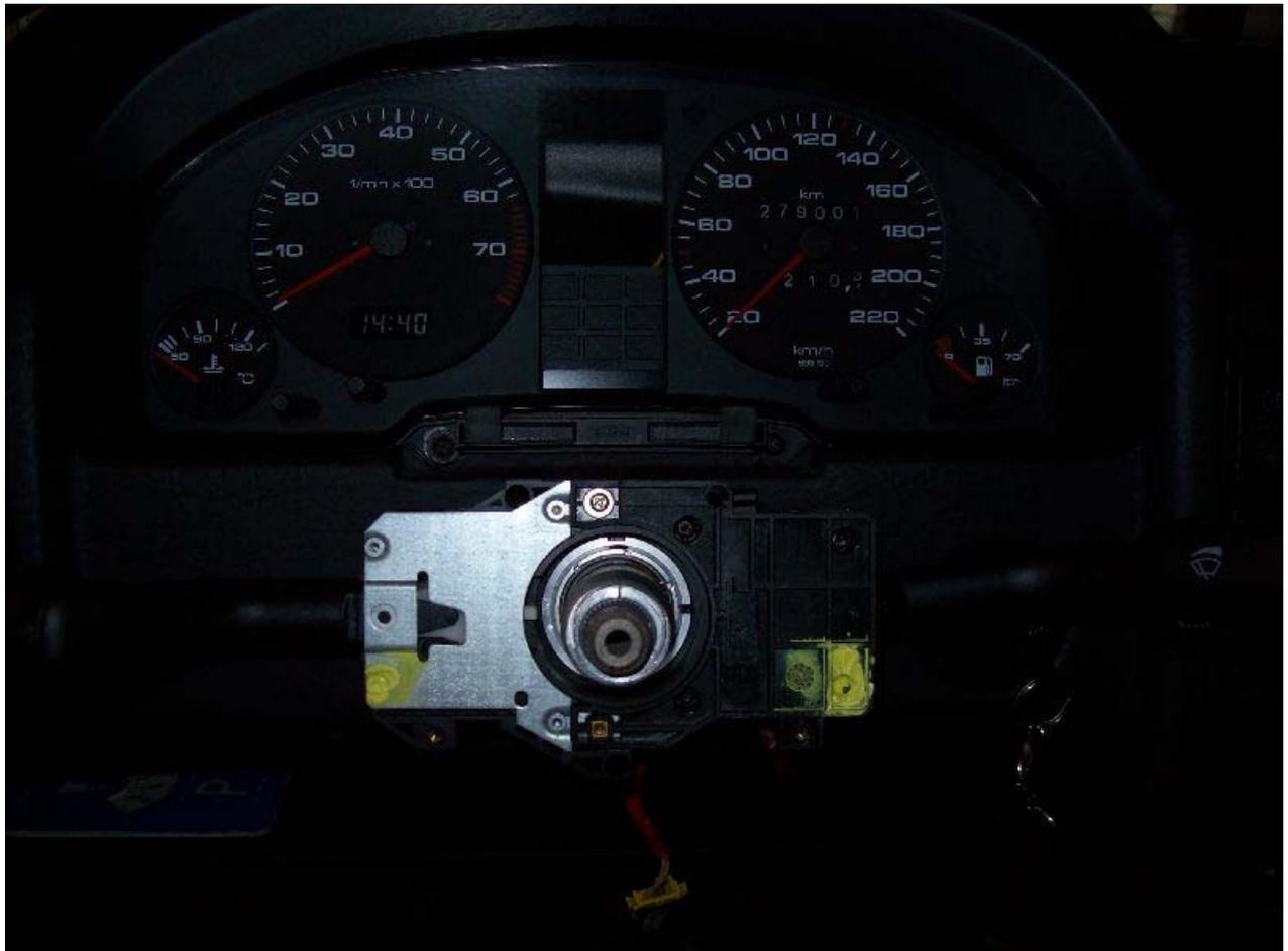
Das Bild zeigt den neuen kompletten Lenkstockscharter, auch zu erkennen ist die Hülse auf der Lenksäule als auch die Hülse zur "Verdickung" der LSS!
