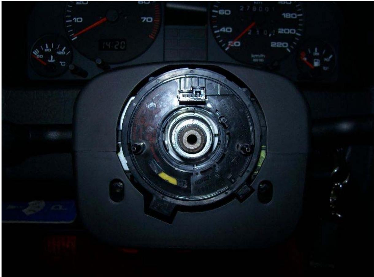
Bevor Wir nun die Kabel zum Lenkrad hin anschließen, probieren wir, ob der Schleifring durch das Lenkrad auch "betätigt" wird. Bei mir war dies nicht der Fall, da ich den LSS so weit nach hinten geschoben habe, um dort keine Lücke zwischen Verkleidung und Amaturenbrett zu haben. Deshalb habe ich ein einfaches Distanzstück dort aufgeschraubt, wo der Stift mit der Feder aus dem Schleifring heraussteht!
